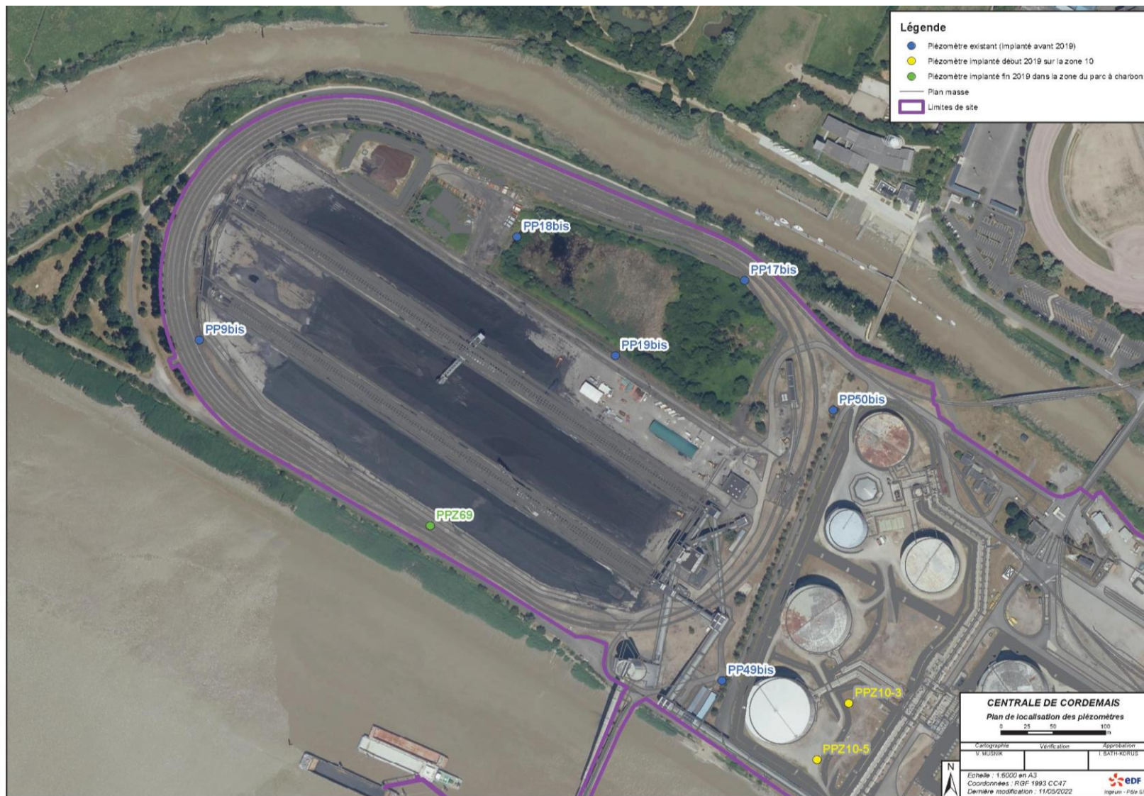
Figure 13 : Localisation des piézomètres aux abords de la zone de stockage des granulés
